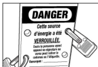
Figure 3 : Exemple de plusieurs cadenas attachés à une étiquette de verrouillage
