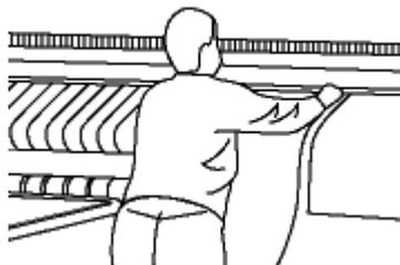
Figure 6 - Alimenter la sécheuse rotative
