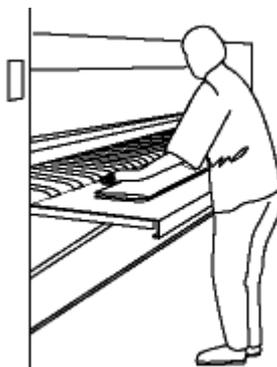
Figure 8 - Récupérer le linge de la sécheuse rotative
