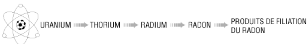
Figure 1 – Production du radon et des produits de filiation du radon à partir de l'uranium.
