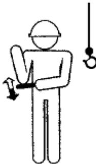
Utiliser le treuil auxiliaire
