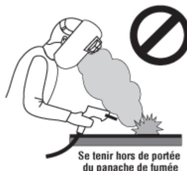
La ventilation avec apport naturel d'air neuf ne doit pas être utilisée pour ventiler un espace clos, un espace comportant des obstacles structurels à la circulation naturelle de l'air ou encore lorsque les contaminants en suspension dans l'air contiennent une substance cancérigène ou d'autres substances à haute toxicité. La norme CSA W117.2 renferme des lignes directrices précises à ce sujet.
